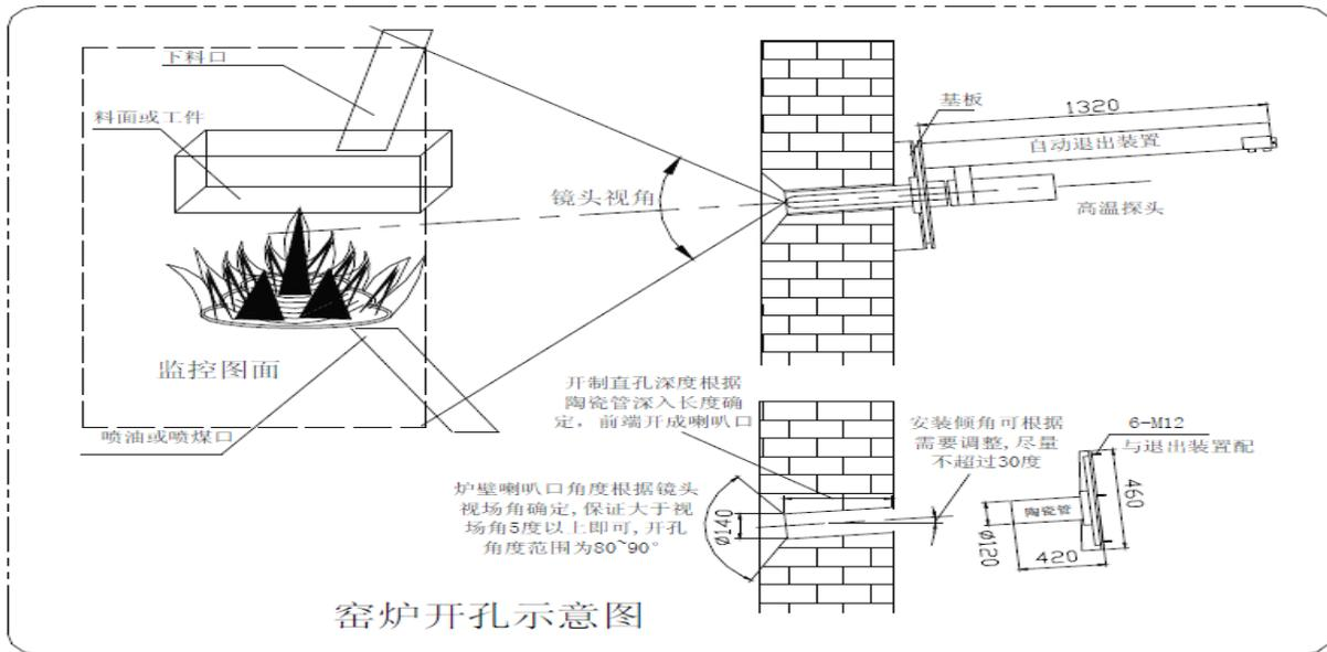
用户厂家必须在加热炉壁上开安装孔,按照我们所提供的炉壁开孔尺寸图,选择最佳观察炉内目标位置开孔。对有些锅炉内部管道较多的设备,需要在锅炉生产设计时预留开孔位置。开孔的要求是在开孔口中心500mm 为半径的范围内应无任何障碍物。
